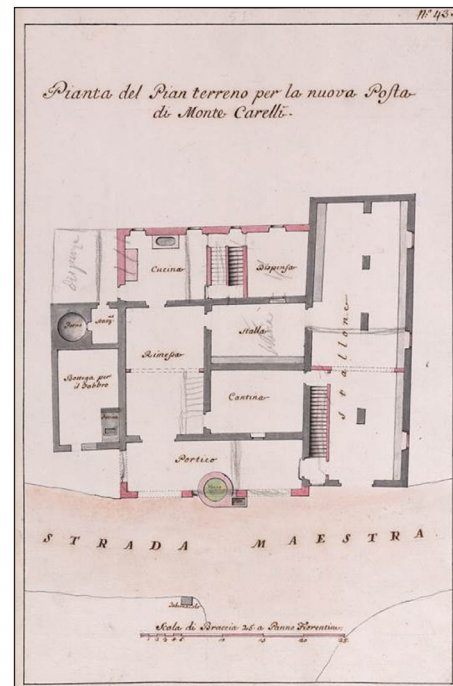
Figure 6: Plan of the ground floor for the new coaching inn of Montecarelli (1765). Image courtesy of ASFI, Piante dello Scrittoio delle Regie Possessioni , tomo IV, Disegni segnati col numero 43.
