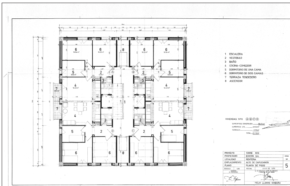
Figure 22: Standard floor plan of a tower of Polígono Capuchinos (70-Er), in Errenteria (1970), by Félix Llanos. Archivo Municipal de Errenteria.
